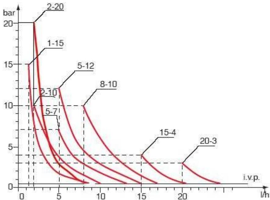
Діаграми на рис. 3 показують максимальний перепад продуктивності насоса в залежності від робочого тиску системи: на діаграмах враховані втрати на інжекторі. В процесі вибору моделі насоса ми рекомендуємо враховувати, що технічні характеристики нашого обладнання при максимальному навантаженні можуть мати похибку 5%.
