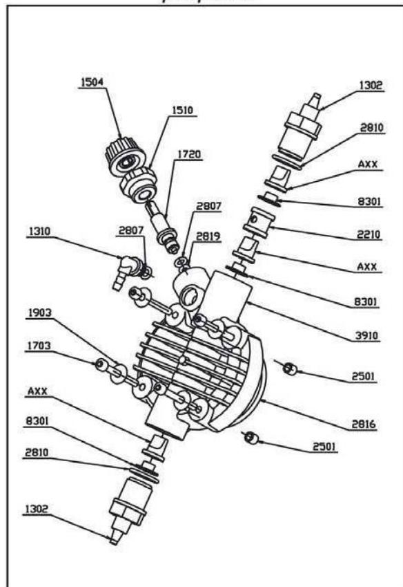
Elettromagnete Completo - Complete Electromagnet
