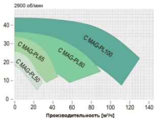
**M PUMPS STD (ПРИВОД ЧЕРЕЗ МАГНИТНУЮ МУФТУ)**
